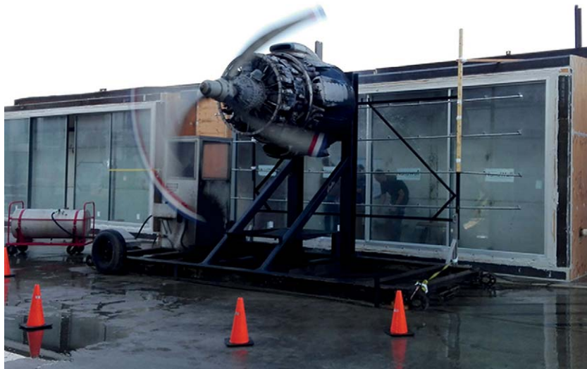
Solarlux-Systeme im Hurrikan-Test: Ein großer Propeller schleudert Wasser auf die Glasflächen. (Foto: Solarlux GmbH).
