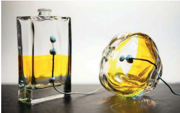
Fläschchen mit angebrachten Thermo- elementen. (© PhoenixTM GmbH)
