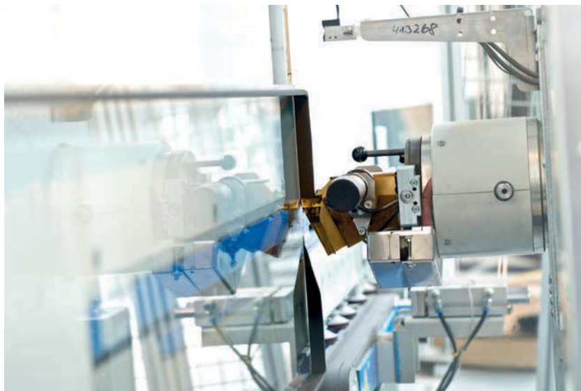
Ködispace 4SG von H.B. Fuller | Kömmerling wird vollautomatisch auf die Scheibe appliziert und bietet bei einer einzigartigen Optik höchste Energieeffizienz und maximale Lebensdauer. (Bildnachweis: H.B. Fuller | KÖMMERLING)
