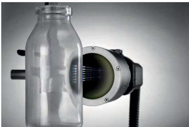
Berührungslose Dickenmessung von Behälterglas. (© VMA GmbH)
