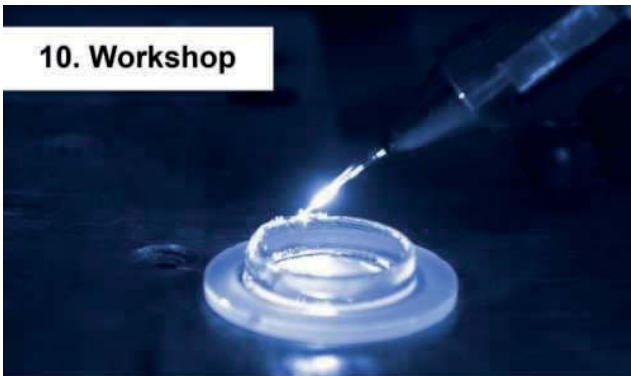
Laserbearbeitung von Glaswerkstoffen
